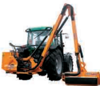
Small DEUTZ AGROFARM 85 Motore 85 cv, 4 cilindri, turbo FERRI TSE 58 Energy Telescopica
